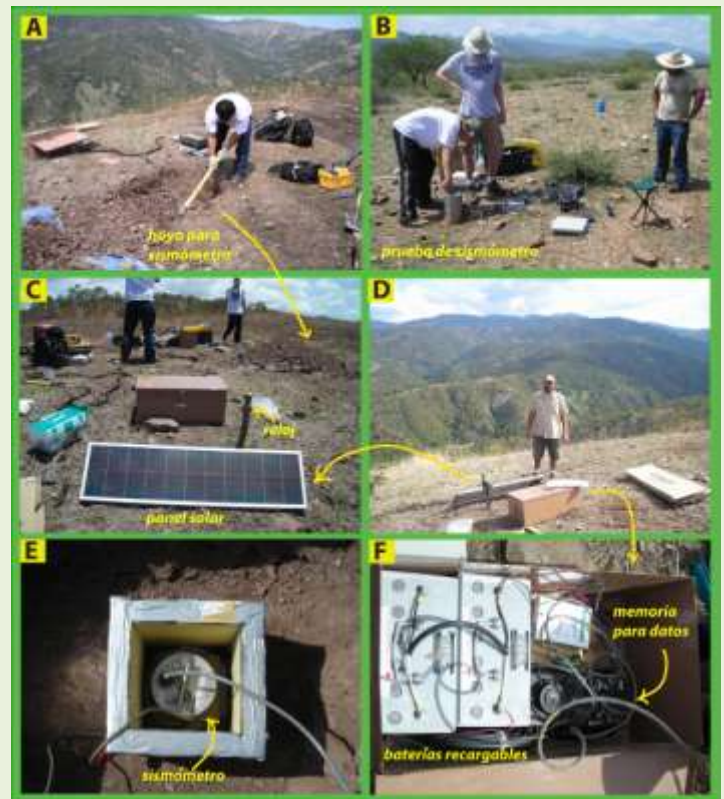
Figura 3. Fotografías de los componentes de una estación sísmica de la red de sismómetros instalada por la Universidad de Miami para la identificación y estudio del fenómeno Tremor-No Volcánico.
